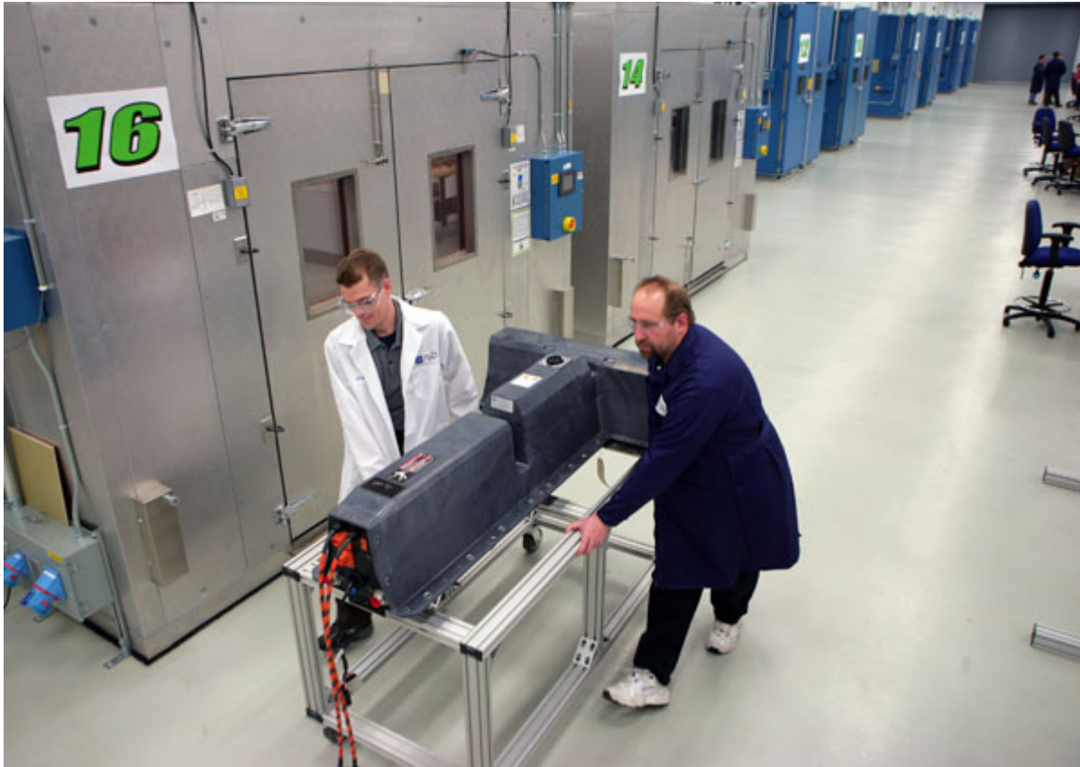
Τεχνικοί της General Motors μεταφέρουν το συγκρότημα (σχήματος T) μπαταριών ενός Chevrolet Volt, στο νέο μεγάλο ερευνητικό κέντρο μπαταριών (Global Battery Systems Battery Lab) της εταιρίας.
